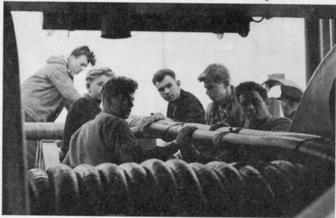
Uitzetten scheerbord met drijver (voor verankerd mijnenvegen)
